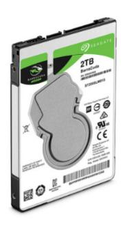
硬盘是一种采用磁介质的数据存储设备,数据存储在密封于洁净的硬盘驱动器内腔的若干个磁盘片上。这些盘片一般是在以的片基表面涂上磁性介质所形成,在磁盘片的每一面上,以转动轴为轴心、以一定的磁密度为间隔的若干个同心圆就被划分成磁道(track)□每个磁道又被划分为若干个扇区(sector)□数据就按扇区存放在硬盘上。在每一面上都相应地有一个读写磁头(head)□所以不同磁头的所有相同位置的磁道就构成了所谓的柱面(cylinder)□传统的硬盘读写都是以柱面、磁头、扇区为寻址方式的(CHS寻址)。硬盘在上电后保持高速旋转,位于磁头臂上的磁头悬浮在磁盘表面,可以通过步进电机在不同柱面之间移动,对不同的柱面进行读写。所以在上电期间如果硬盘受到剧烈振荡,磁盘表面就容易被划伤,磁头也容易损坏,这都将给盘上存储的数据带来灾难性的后果。
